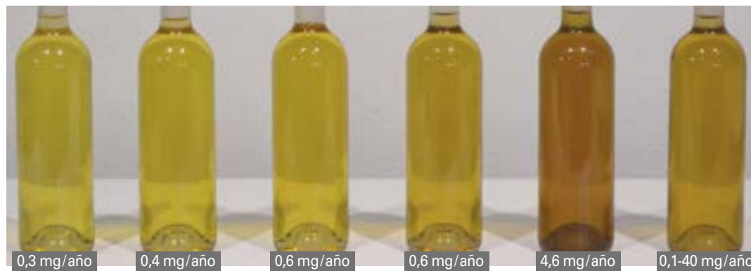
Figura 2: Ilustración del impacto del OTR de obturadores sobre la intensidad de la tonalidad amarillo-naranja de un vino Sauvignon (Gd-M) tras 10 años de guarda (clasificación de muestras según los valores del OTR de la tabla 1 ).
